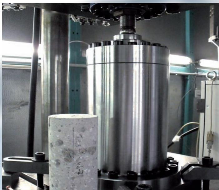
Der Umfangsdruck wird durch ein Hydraulikaggregat, das wahlweise statisch oder dynamisch über ein Servoventil angesprochen wird, erzeugt. Insgesamt gesehen ist dies ein hocheffizientes und schnelles
