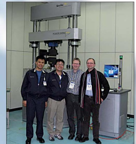
Der POWER SWING 600 kN kann in einem Frequenzbereich von 40...100 Hz und einem Schwingweg von 10 mm eingesetzt werden. Die maximale Kraftamplitude beträgt ± 300 kN. Ansprechpartner: Helge Zorrmann E-Mail: h.zorrmann@sincotec.de
