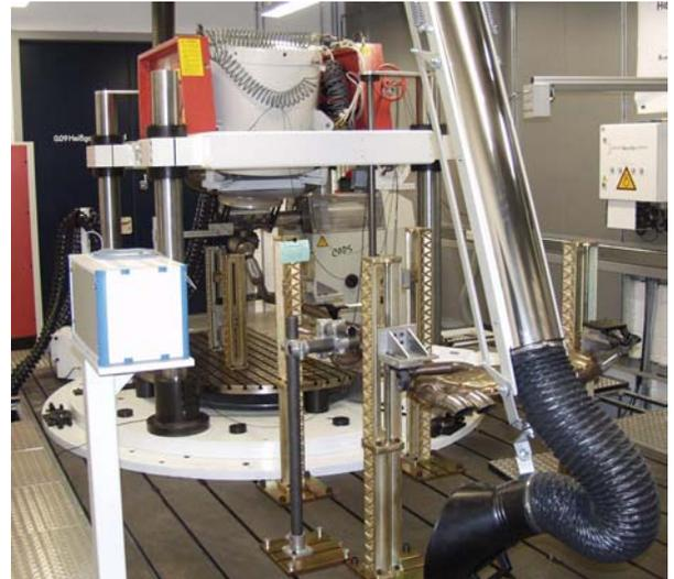
Gesamt-Abgasanlagenprüfstand "HOT SWING 350"
